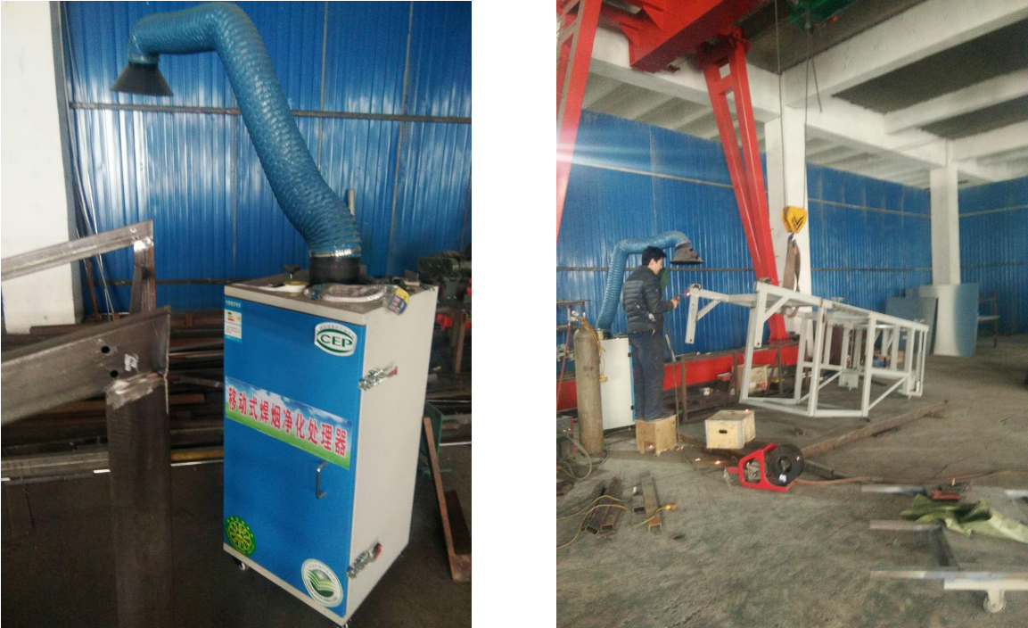
图 4-1 项目移动式焊接烟尘净化器现场照片
